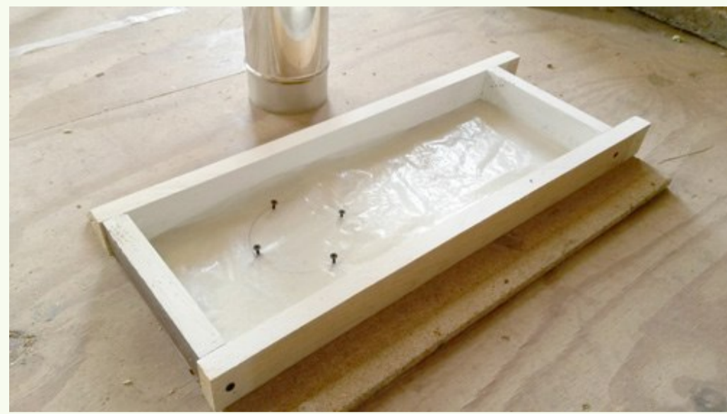
Peça de exaustão 550x200x50 mm com abertura Ø 122 mm para saída de fumo
