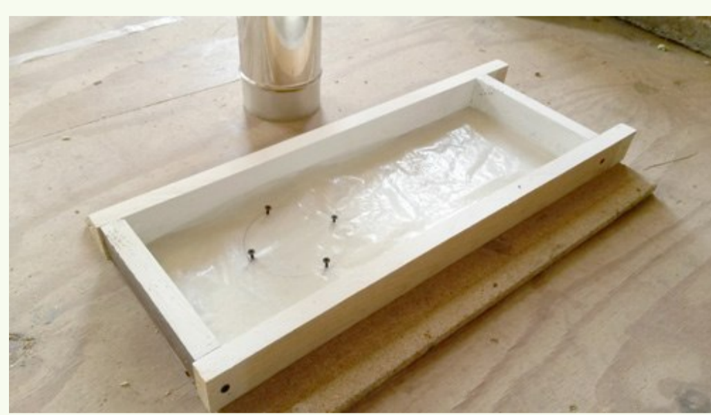
Uitlaatstuk 550x200x50 mm met een Ø 122 mm opening voor de rookafvoer
